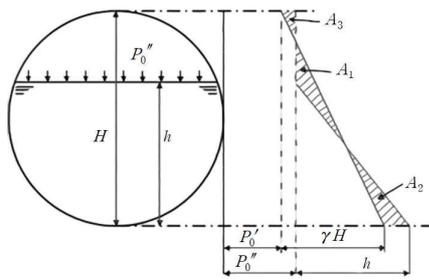
그림 16.5 압력배출상태에서의 내압 모의시험
