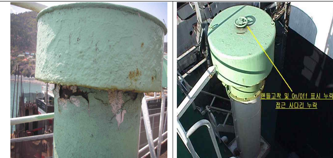
8. 코밍과 폐쇄장치를 포함하여 통풍통, 공기관에 대한 검사 (규칙 2장 202.의 1항 (6)호)
