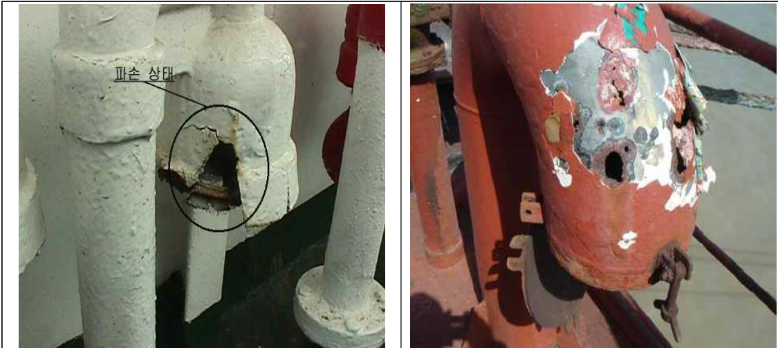
7. 노출감판 상에 설치된 모든 공기관헤드에 대한 외관검사 (규칙 2장 202.의 1항 (1)호 (사))
