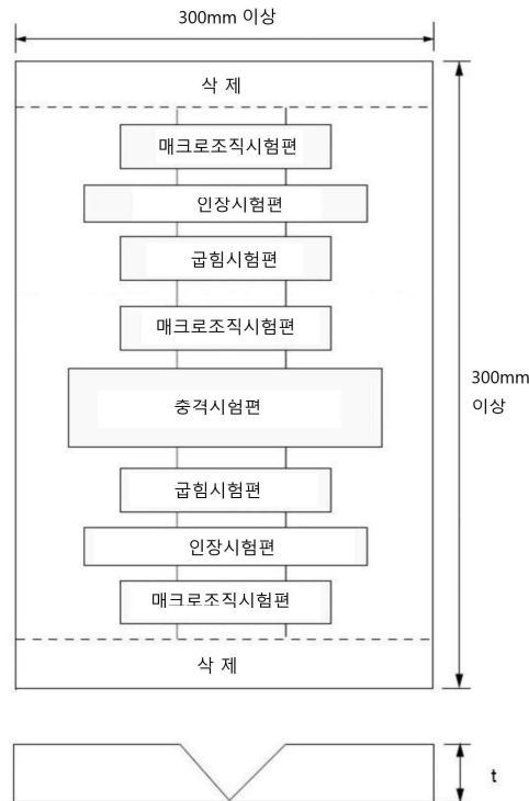
그림 2.1.16 용접보수절차 시험편
