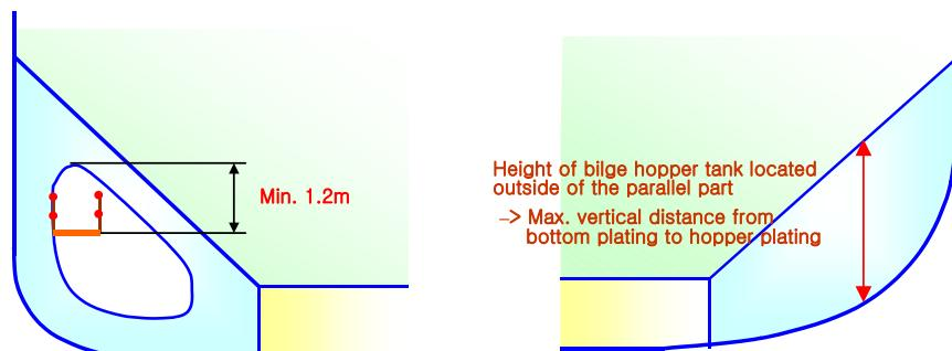
2.5.2 최소폭 600 mm의 넓은 폭 종단콜은 종방향 연속적인 영구 접근설비로 사용될 수 있다. 높이 6 m 이상인 경사진 바닥을 갖는 최전방 및 최후방의 벨지 호퍼 평형수 탱크에 대하여, 각 트랜스버스 웨브에 대한 측면 외판과 연결된 호퍼 탱크의 경사진 판의 접근을 위하여 횡방향 및 수직방향 접근설비를 결합한 수단을 종방향 영구 접근설비를 대신하여 사용할 수 있다.
