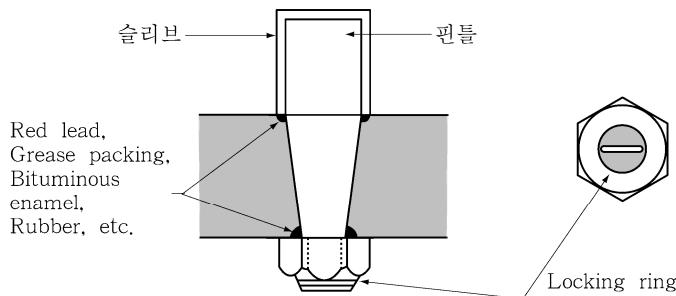
그림 4.1.13 펀틀 너트의 고정장치 및 펀틀의 부식방지장치
