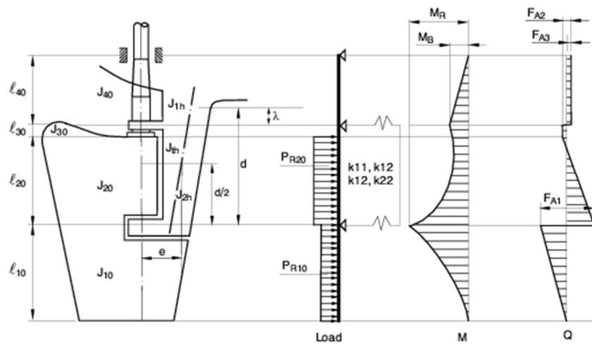
그림 4.1.7 *E* 형 타(2점(2-conjugate) 탄성지지되는 세미스페이드 타)
