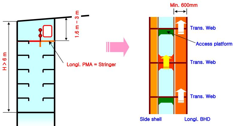
2.1.2 웨브프레임(webframe)에 필요상 설치된 플랫폼에 의해 반대편 주요 상세부로 접근가능하다면 넓은 폭 종득골(wide longitudinal)은 연속된 영구 접근설비가 될 수 있다. 웨브면의 수직 개구가 넓은 폭 종득골과 반대편 종득골 사이의 개방된 부분에 있는 경우, 웨브를 안전하게 통과하기 위하여 웨브 양쪽에 플랫폼이 제공되어야 한다. 기술규정 1.4항에 언급된 10 % 이내의 적절한 편차(reasonable deviation)는 영구접근설비가 구조와 일체화 된 경우에 적용될 수 있다.
