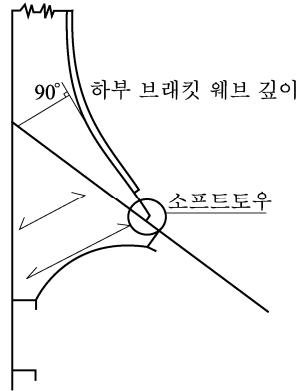
그림 7.3.24 t_{REN,d/t} 를 결정하기 위한 하부 브래킷 웨브깊이의 정의
